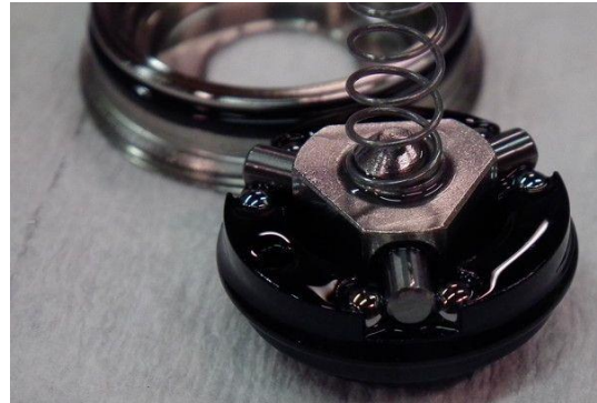
6. ábra: Renishaw TTP kontaktusrendszere
