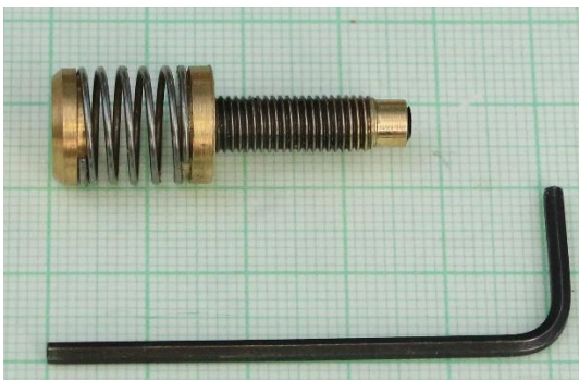
19. ábra: Rugós erőgenerátor
