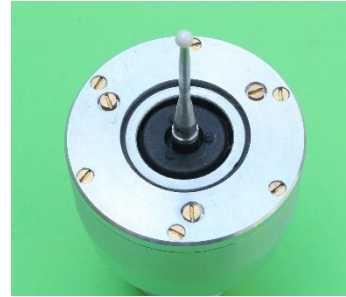
13. ábra: Szennyeződésektől védő, egyben fényzáró rugalmas védőharmonika
