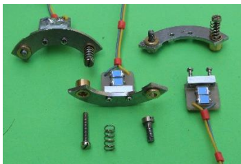
11. ábra: A három finomállító mechanika a fotodióda-párokkal, beépítés előtt
