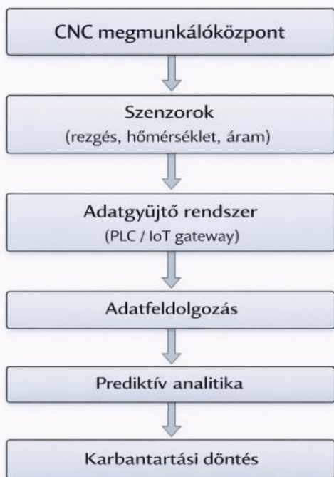
4. ábra: Prediktív karbantartási rendszer architektúrája Ipar 4.0 környezetben
