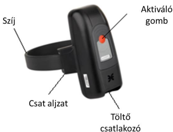
1. ábra: Egy részes nyomkövető eszköz felépítése [8]
