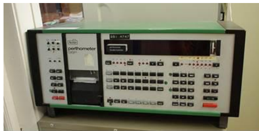
6. ábra: A Mahr S6P berendezés vezérlőegysége a Bánkin
