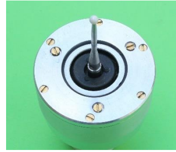
13. ábra: Szennyeződésektől védő, egyben fényzáró rugalmas védőharmonika
