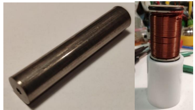
3. ábra: Ferromágneses fémtest és fűtő tekercs
