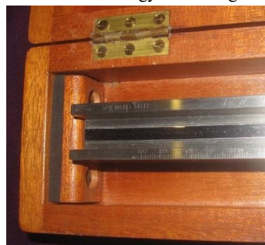
20. ábra: Egy H-profilú, milliméter-segédosztásos etalon. (Hilger & Watts, 1948)
