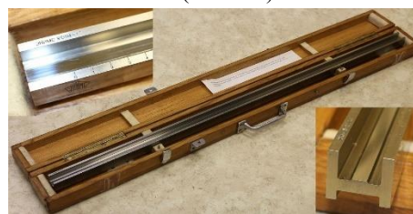
19. ábra: Az ENyIMSZ milliméterosztásos etalon (Az MKEH-ben fotózta a szerző)
