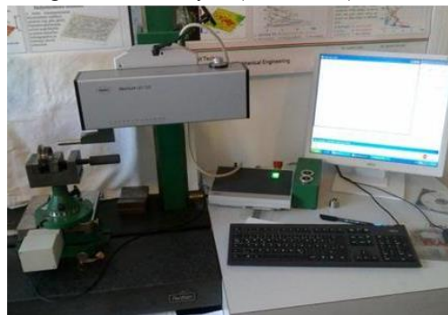
15. ábra: Mahr GD 120-as vontatóegység az állványon a Bánki érdességmérő laborjában
