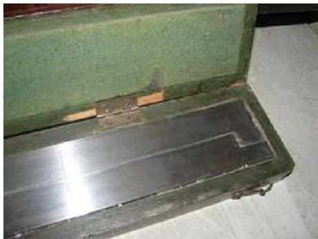
1. ábra: Egy toise du Pérou -hoz hasonló, egymásba illeszkedő etalonpár végkialakítása
