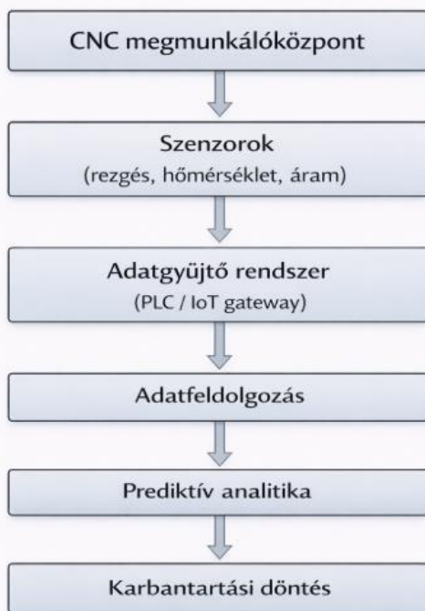
4. ábra: Prediktív karbantartási rendszer architektúrája Ipar 4.0 környezetben
