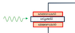
11. ábra: A Josephson-etalon sematikus ábrája
