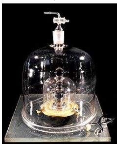
9. ábra: A tömeg etalonja 2019-ig
