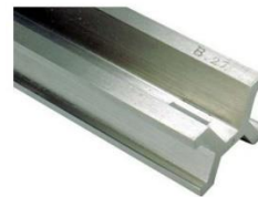
17. ábra: Az USA 27. számú méteretalonjának „B” vége
