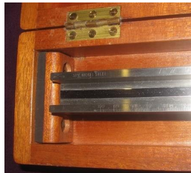
20. ábra: Egy H-profilú, milliméter-segédosztásos etalon. (Hilger & Watts, 1948)
