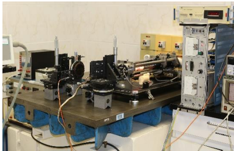
27. ábra: Thomson gyártmányú jódstabilizált He-Ne lézer. (Az MKEH-ben fotózta a szerző 2016-ban)
