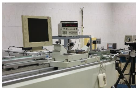
28. ábra: Mérési összeállítás a Zeiss hossz mérőgéppel és a HP lézertinterferométerrel. (Az MKEH-ben fotózta a szerző 2016-ban)
