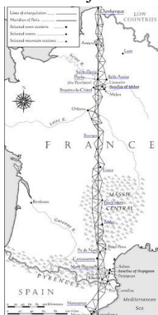
6. ábra: A mérendő ívszakasz térkép-vázlata az egyszerűsített háromszögelési hálózattal, amelyen a két alapvonalat ( baseline ) is feltüntették
